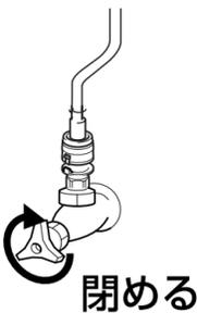
●施工後、お客様へのお引き渡しまでは、必ず元栓を閉じて水栓内部の水を抜いておいてください。
