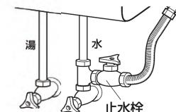
**18** 接続部からの水漏れがないことを確認し、そのまま3分以上放流して、カートリッジ内の不安定な吸着材や空気を出します。
