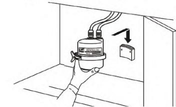
**17** 水側の分岐後の止水栓を開栓し、浄水レバーを上げて通水します。
